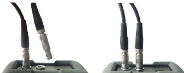
Рисунок 2.2 – Подключение преобразователей к прибору
