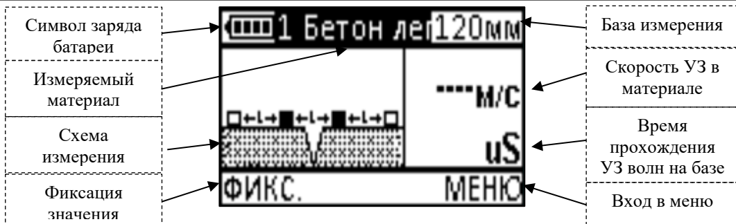
Рисунок 2.9 – Режим определения глубины трещины по английской методике
