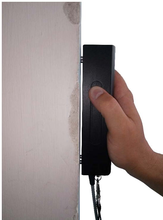
Рисунок 2.5 – Установка преобразователя на поверхность контролируемого объекта
