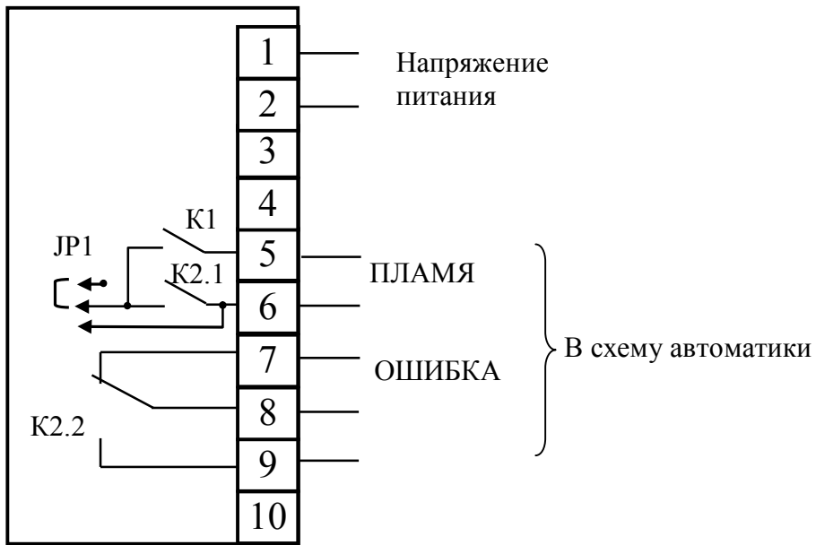
Рис. 4. Схема подключения датчика-реле пламени ПАРУС-002УФ-1/**Е.
