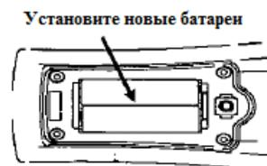
5. Установите крышку батарейного отсека на прибор, совместив специальные выступы на крышке и приборе. Прижмите крышку вниз, толкая ее в направлении стрелки, как это указано на рисунке.
