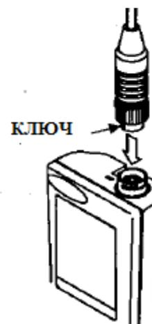
3. Поверните фиксирующее кольцо. Не прилагайте чрезмерных усилий при подключении, это может привести к физическому повреждению разъема.
