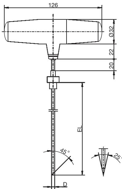
Тип 902930/10 с рабочим соединением
