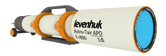
Телескоп Levenhuk Astro-Tair APO F=800 1:8 — рефрактор-апохромат, отличающийся от аналогичных по параметрам тем, что обеспечивает плоское поле изображения в пределах 2 дюймов благодаря встроенному корректору. Благодаря крупной апертуре, исправленным сферохроматическим аберрациям и большому рабочему полю изображения этот телескоп подходит для профессиональной и любительской астрофотографии с использованием различных камер вплоть до формата сенсора 44х33 мм.
