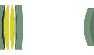
Оптическая схема объектива телескопа состоит из 5 элементов, 2 элемента из низкодисперсного стекла. Изобретателями принципиальной схемы «АПО Таир», построенной на монокристаллическом флюорите, являются Д.С. Волосов и А. Монастырский. Настоящая оптическая схема рассчитана с использованием современных оптических материалов и улучшена в соответствии с последними достижениями оптического стекловарения.
