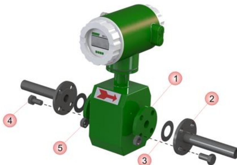
Рисунок 2.3 – Установка расходомера ЭМИС-МАГ 270 на трубопровод
