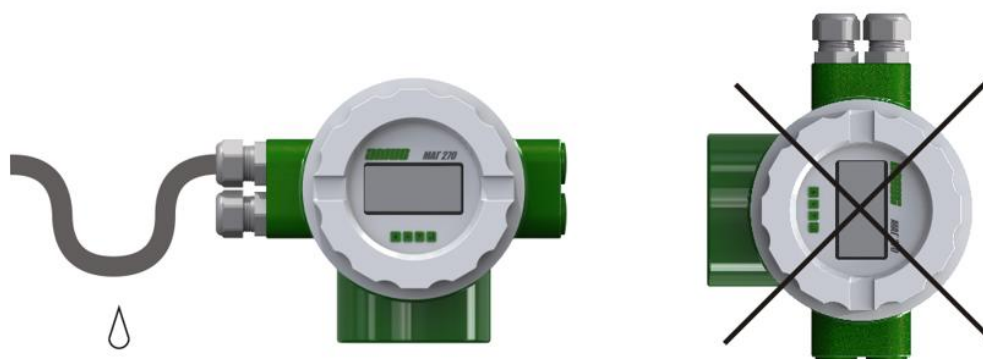
Рисунок 2.8 - Рекомендации по расположению кабелей и кабельных вводов
