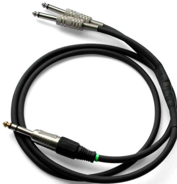
Рисунок 4.9 – Распайка кабеля для подключения трансивера к линейному выходу звуковой карты
