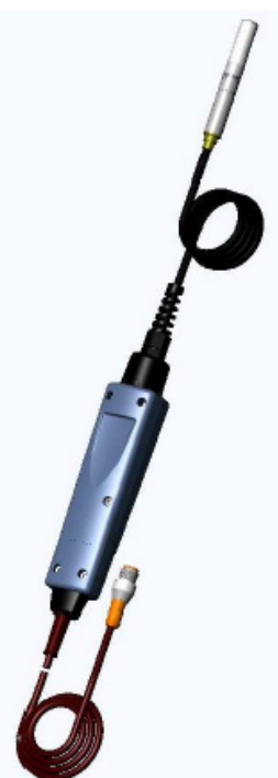
Датчик HMP 77 Датчик с кабелем для промышленных процессов до 180°C. В наличии модификация с предварительным нагревом и химической очисткой (HMP 77B)
