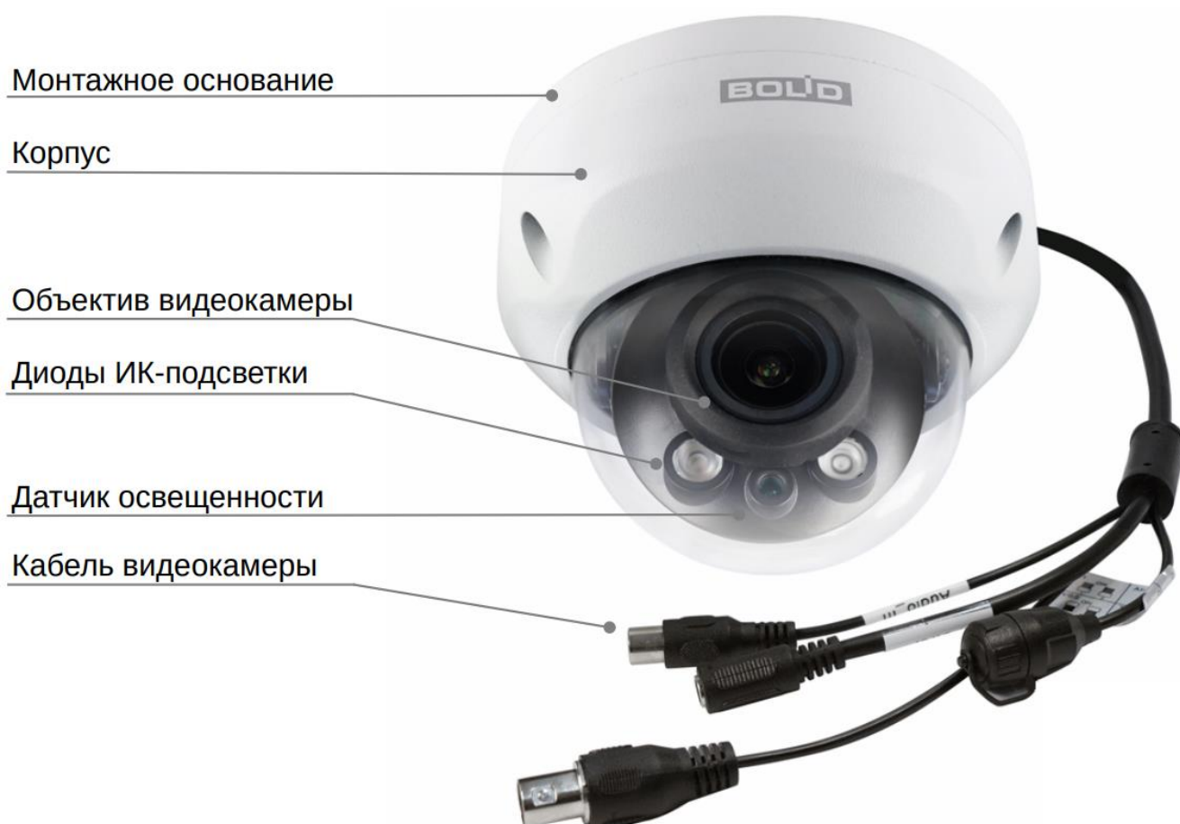
Рисунок 4.1 – Внешний вид и основные элементы видеокамеры
