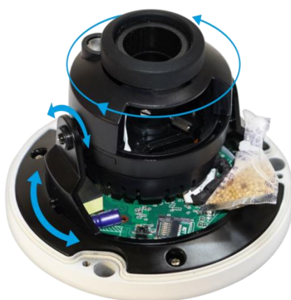
Рисунок 6.5 – Настройка направления объектива
