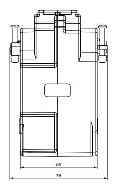
Вариант с установленными кронштейнами поз.6
