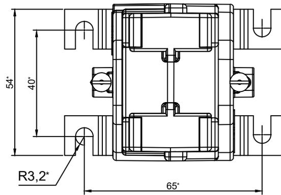
Вариант с установленными кронштейнами поз.5 для установки на DIN-рейку (35 мм)
