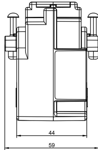
Вариант с установленными кронштейнами поз.6
