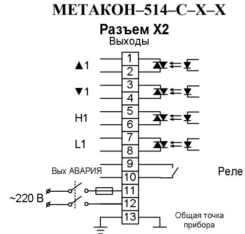
Рисунок 13 – Схемы подключения выходных цепей к клеммным соединителям для модификаций МЕТАКОН-514-С-Х-Х
