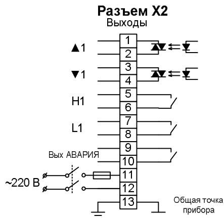
Рисунок 14 – Схемы подключения выходных цепей к клеммным соединителям для модификаций МЕТАКОН-514-СР-X-X
