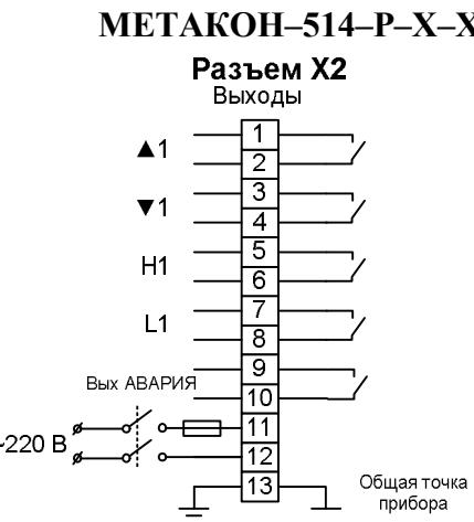
Рисунок 12 – Схемы подключения выходных цепей к клеммным соединителям для модификаций МЕТАКОН-514-Р-Х-Х
