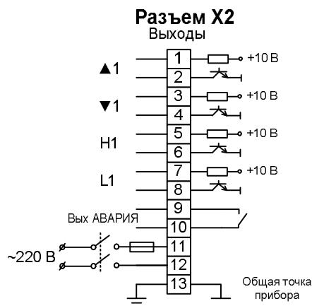
Рисунок 15 – Схемы подключения выходных цепей к клеммным соединителям для модификаций МЕТАКОН-514-K-X-X
