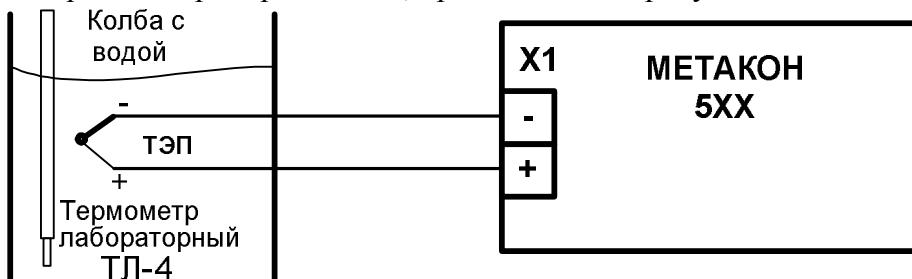
Рисунок А.6.3.1.2 – Схема подключения приборов мод. МЕТАКОН-5ХХ - ТП для поверки погрешности компенсации влияния температуры холодных спаев.
