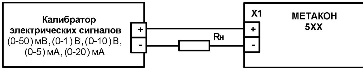
Рисунок А.6.3.1 – Схема подключения приборов мод. МЕТАКОН-5XX
