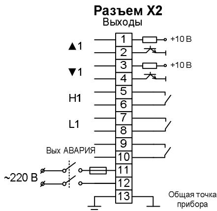
Рисунок 16 – Схемы подключения выходных цепей к клеммным соединителям для модификаций МЕТАКОН-514-КР-Х-Х
