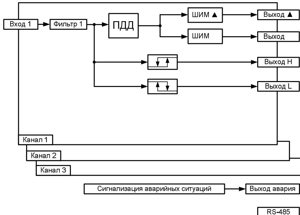
Рисунок 1 – Функциональная схема прибора МЕТАКОН-5x4-Х-Х-Х
