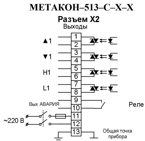
Рисунок 12 – Схемы подключения выходных цепей к клеммным соединителям для модификаций МЕТАКОН-513-С-Х-Х
