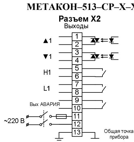
Рисунок 13 – Схемы подключения выходных цепей к клеммным соединителям для модификаций МЕТАКОН-513-СР-X-X
