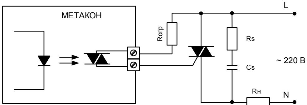
Рисунок 18 – Схема подключения силового симистора к выходу «С»
