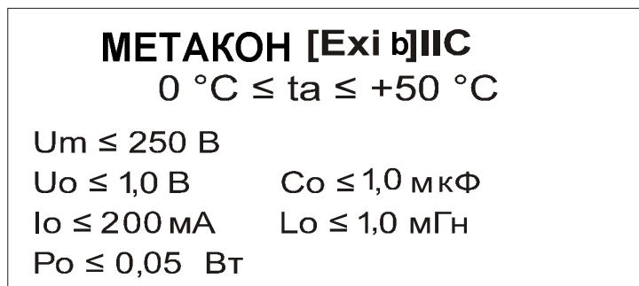
8.10 Приборы серии **МЕТАКОН** могут использоваться в опасном производстве в соответствии с «Условиями применения»:
