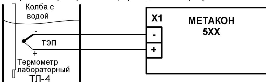
Рисунок А.6.3.1.2 – Схема подключения приборов мод.МЕТАКОН 5XX-ТП
