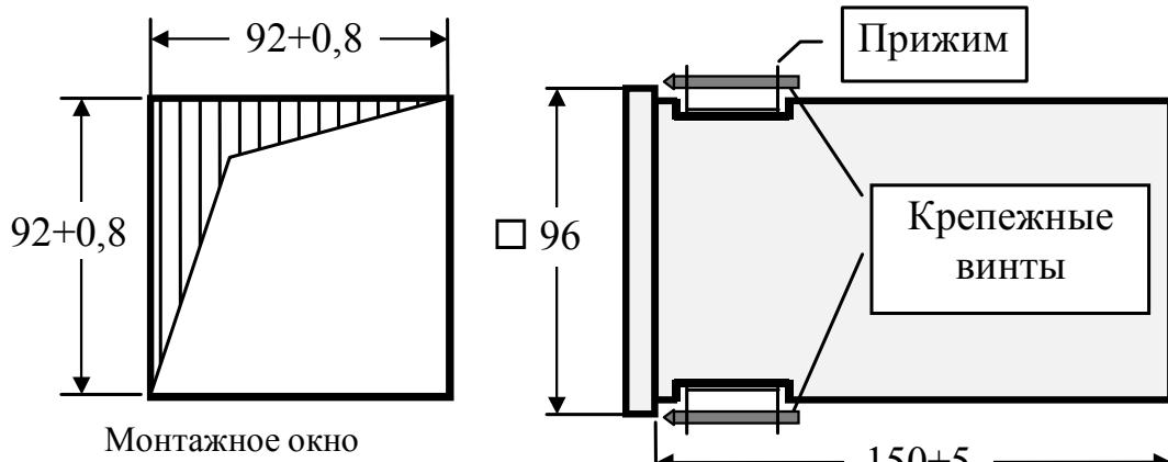
Рисунок 7 – Габаритные и установочные размеры прибора
