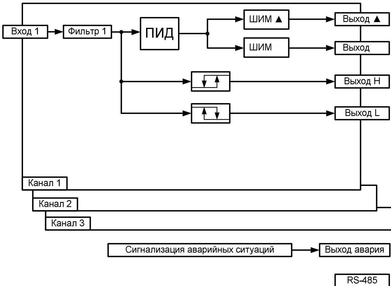
Рисунок 1 – Функциональная схема прибора МЕТАКОН-5x3-Х-Х-Х
