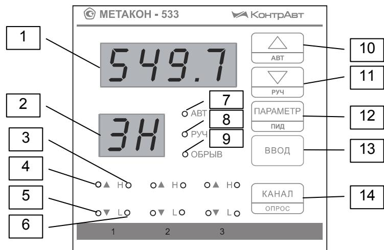
Рисунок 22 – Лицевая панель приборов серии «Метакон-533»
