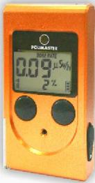
Дозиметр специально разработан для использования в самых неблагоприятных условиях эксплуатации: ограниченная видимость, повышенный шум, высокие температуры, погружение в воду, механические удары и падения. Металлический корпус устойчив к воздействию повышенной температуры 100°C в течение 2 минут. Допускает погружение под воду, включая морскую, на глубину 1м до 2 часов. РМ1605ВТ может обмениваться данными с мобильным устройством пользователя в режиме реального времени.
