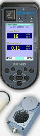
Портативный комплексный прибор радиационного контроля со встроенным модулем GPS с функциями поискового прибора, дозиметра-радиометра и идентификатора радионуклидов. Идентификация изотопов не требует подключения к внешнему устройству обработки и индикации (PC/Ноутбук/КПК и т.д.). Включает встроенный блок детектирования и обработки данных на основе CsI(Tl) и набор внешних блоков детектирования альфа, бета, гамма и нейтронного излучений.
