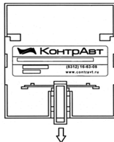
Рисунок 5 – Способы установки блоков при монтаже
