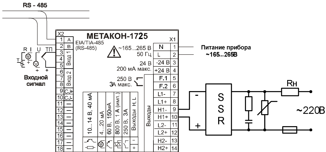
Рисунок 12 – Электрическая схема подключения твердотельного реле к прибору МЕТАКОН-1725-2К/2Р-У-1
