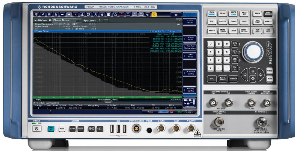
Рисунок 1 – Анализатор фазовых шумов и тестер ГУН-генераторов R&S FSWP. На экране показан результат измерения фазового шума высокочастотного термостатированного кварцевого генератора (ОСХО), для которого уровень шума при отстройке частоты 1 МГц составляет -190 дБн/Гц.
