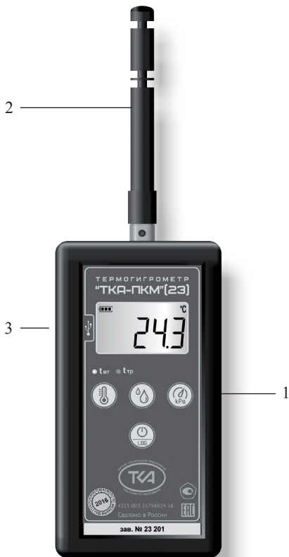
Рис.1 – Внешний вид прибора “ТКА-ПКМ”(23) 1 – Блок обработки сигналов 2 – Зонд с датчиками 3 – Разъём для подключения к ПК
