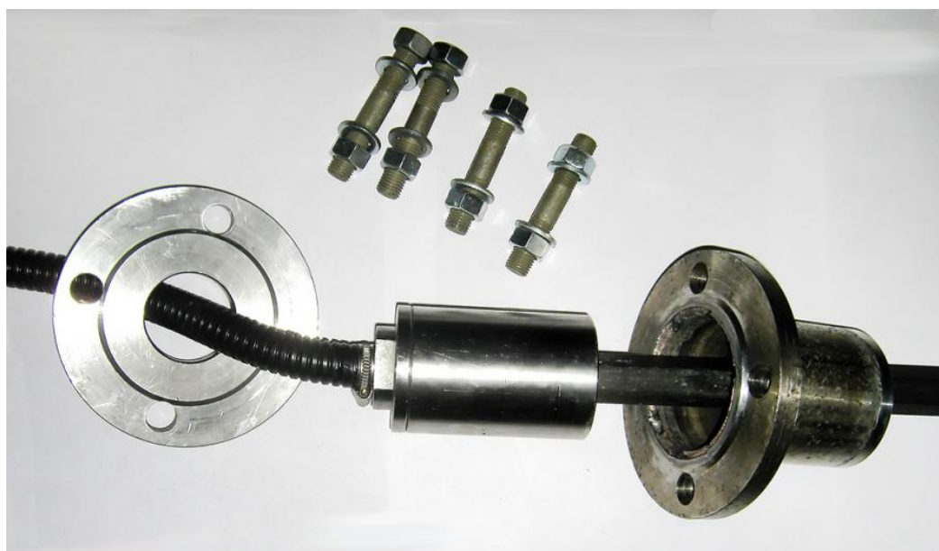
Зонд с передней муфтой, вид конструкции перед фиксацией зонда с помощью фланца
