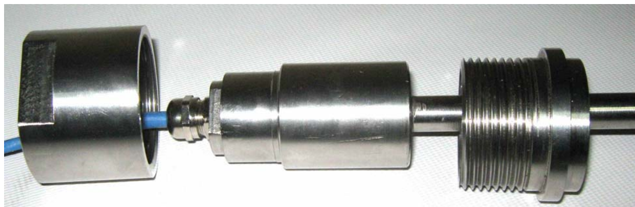
Зонд с передней муфтой, вид конструкции перед фиксацией зонда
