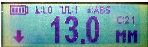
Рис.6.3 Значения толщины объекта контроля выходящие за пределы допуска
