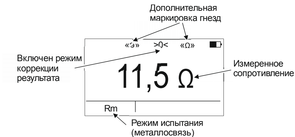
Рисунок 23 - Результат измерения сопротивления металлосвязи
