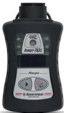
Предназначен для измерения массовой концентрации вредных веществ, в том числе паров нефти и нефтепродуктов в воздухе рабочей зоны и других компонентов с потенциалом ионизации ниже 10,6 эВ.
