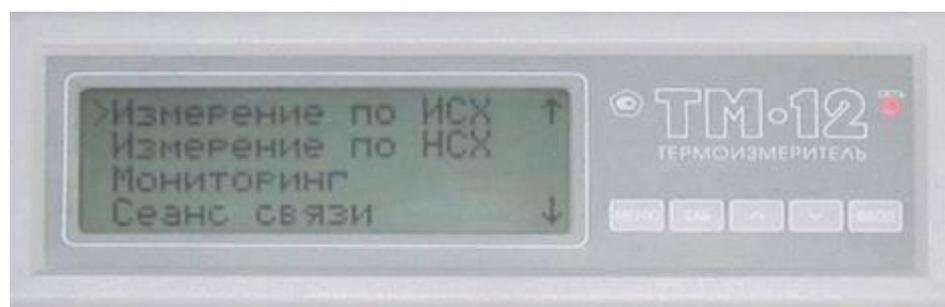
передней панели корпуса (рисунок 2) находятся дисплей, клавиатура и световой индикатор сети.
