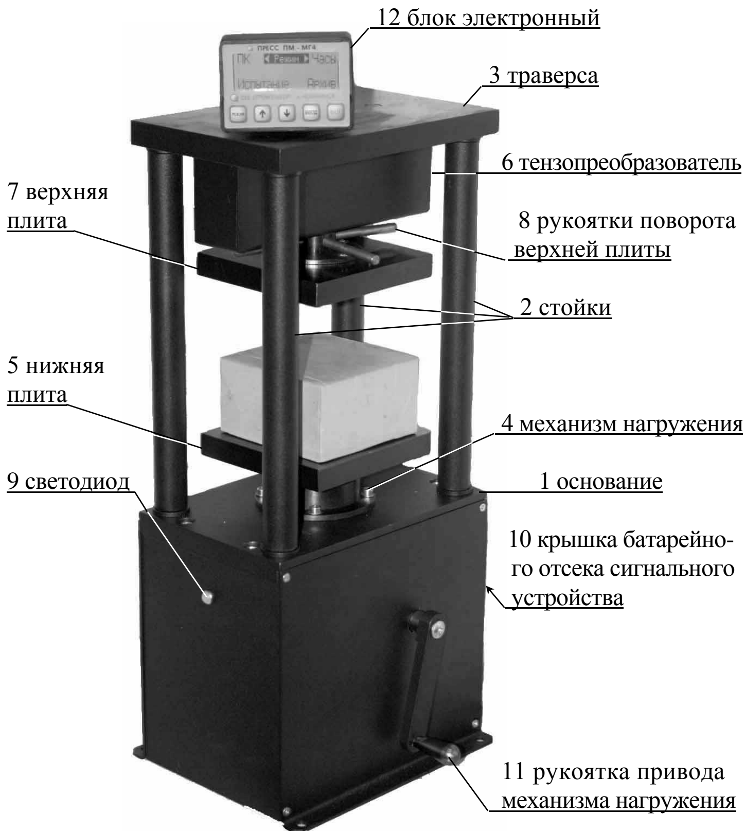
Рисунок 1.4.1. Общий вид пресса ПМ-МГ4 с ручным приводом механизма нагружения
