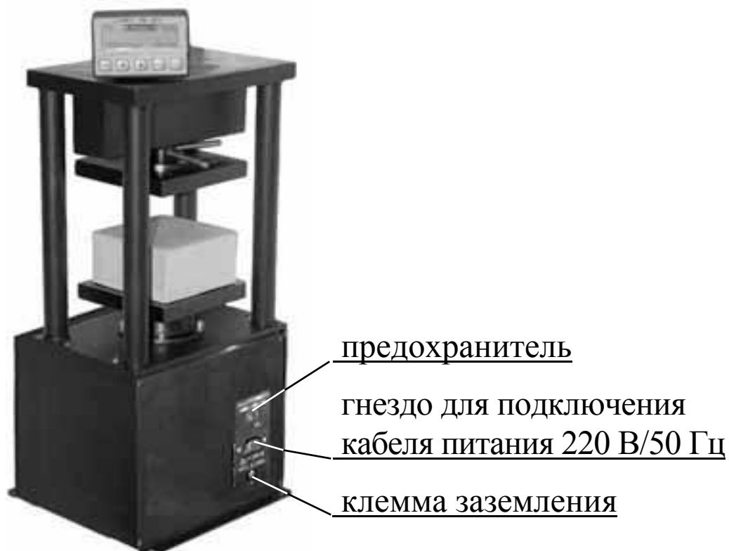
Рисунок 1.4.2.б. Общий вид задней стенки пресса ПМ-МГ4 с электрическим приводом механизма нагружения
