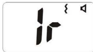
2. В случае если прибор уже включен, нажать на приборе кнопку LIGHT и направить окно приемопередатчика прибора к адаптеру ИК-канала связи на расстоянии 10-20 сантиметров.
