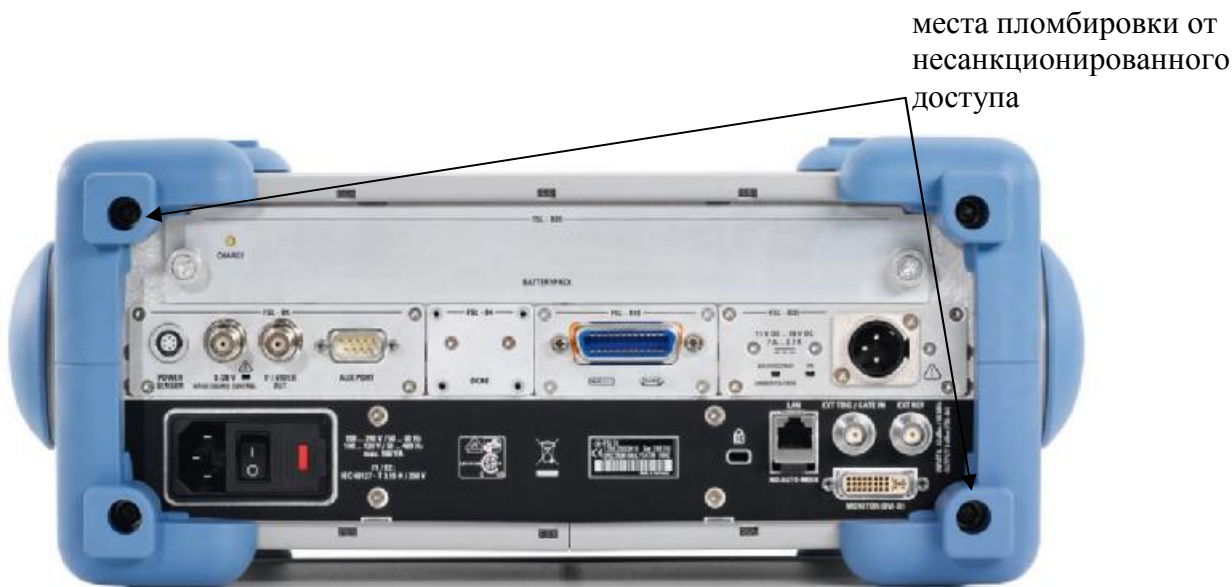
Рисунок 2 - Схема пломбировки от несанкционированного доступа
