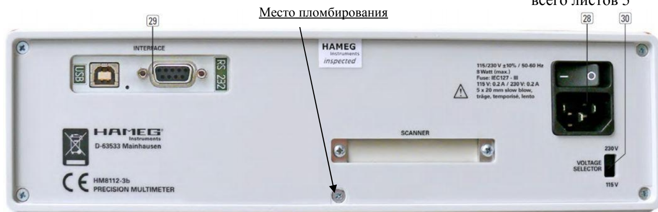
Рисунок 2 – Вид задней панели вольтметра
