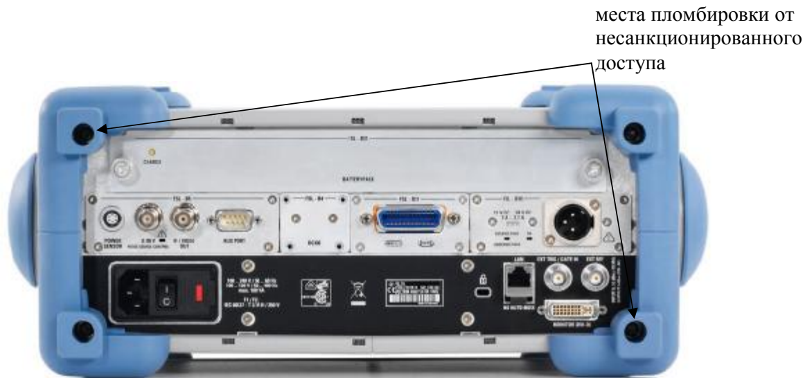
Рисунок 2. Схема пломбировки от несанкционированного доступа.
