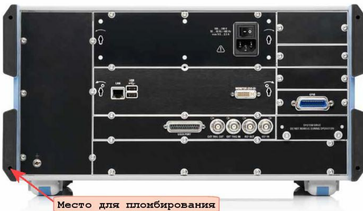
Рисунок 2 – Задняя панель и место для пломбирования анализаторов цепей векторных R&S ZNC3, ZNB4, ZNB8
