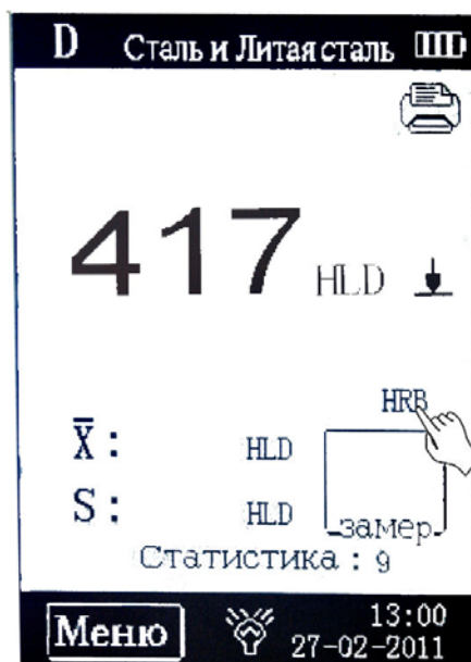
Рис.4-9 Выбор шкалы твердости в режиме измерения
