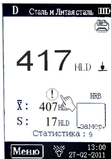
Рис.4-10 Экран прибора при срабатывании сигнализации АСБ
