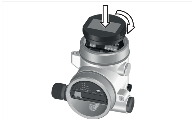
Рис. 31: Установка модуля индикации и настройки
