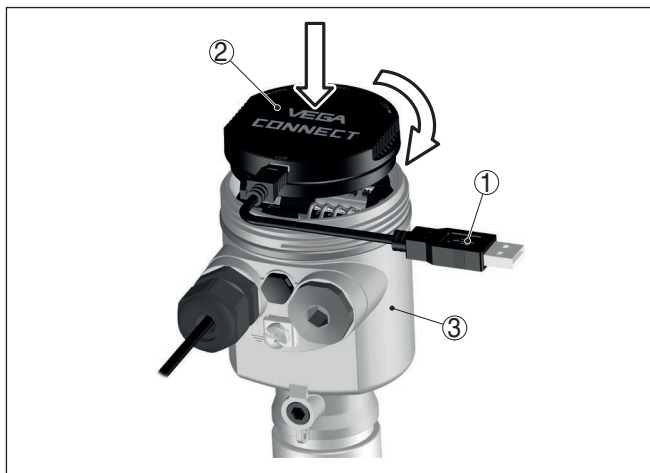
Рис. 24: Подключение ПК через интерфейсный адаптер прямо к датчику
