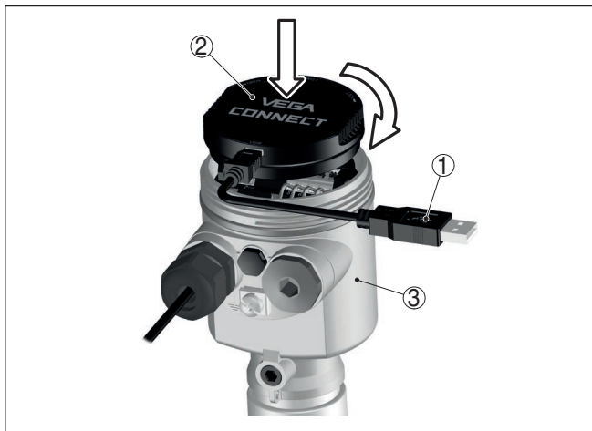
Рис. 39: Подключение ПК через интерфейсный адаптер прямо к датчику
