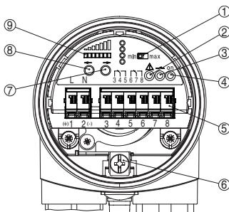
Блок электроники принимающего блока MP60EE.R - релейный выход
