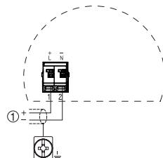
Схема подключения передающего блока - VEGAMIP R62 T (передатчик)
