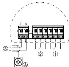
Схема подключения принимающего блока - VEGAMIP R62 R (приемник)
