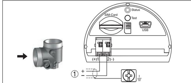
Рис. 22: Отсек подключения встроенного модуля мобильной связи PLICSMOBILE
