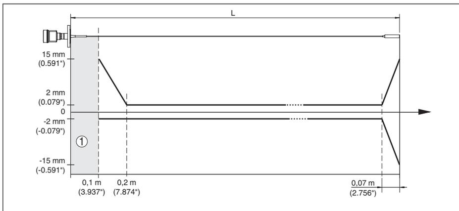
Рис. 43: Погрешность измерения VEGAFLEX 83 в тросовом исполнении с покрытием (среда - вода)
