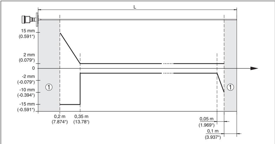
Рис. 42: Погрешность измерения VEGAFLEX 83 в стержневом исполнении с покрытием (среда - масло)
