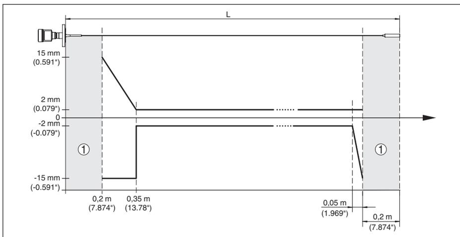
Рис. 44: Погрешность измерения VEGAFLEX 83 в тросовом исполнении с покрытием (среда - масло)
