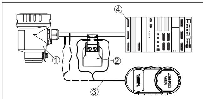
Рис. 28: Подключение ПК к сигнальному кабелю через HART
