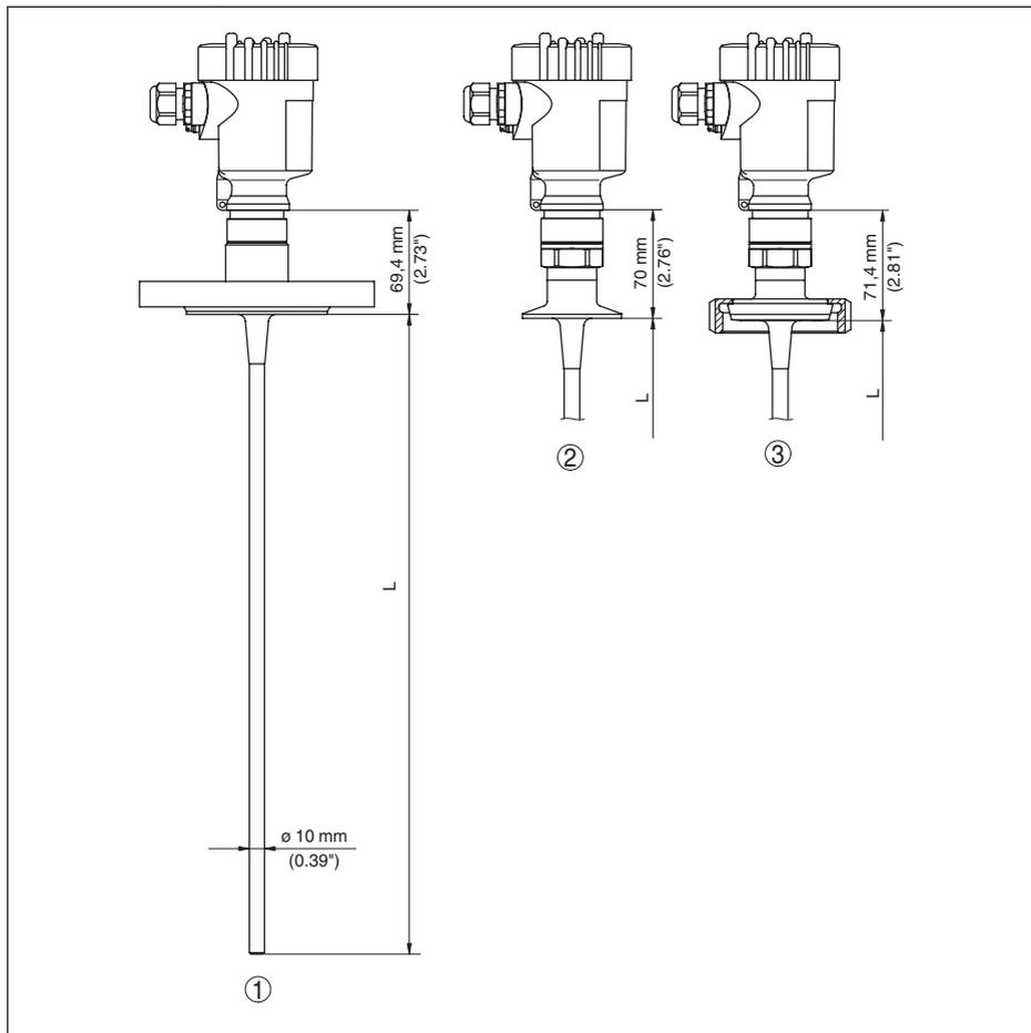
Рис. 52: VEGAFLEX 83, стержневое исполнение
