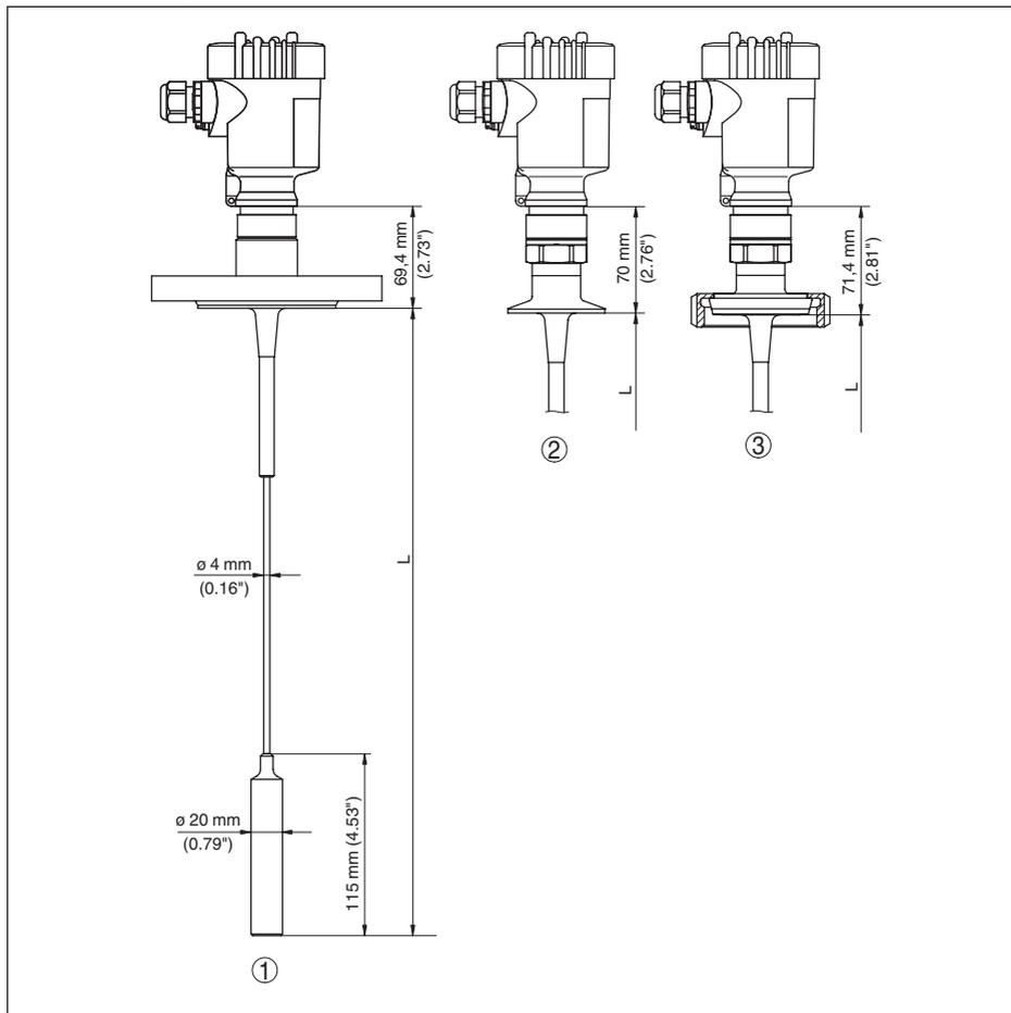
Рис. 51: VEGAFLEX 83, тросовое исполнение с натяжным грузом
