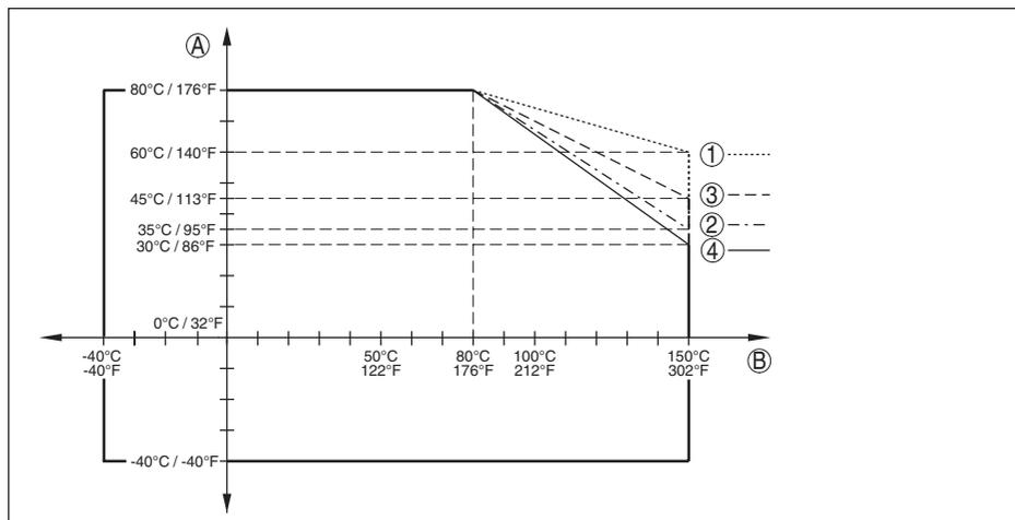
Рис. 45: Температура окружающей среды - температура процесса, стандартное исполнение
