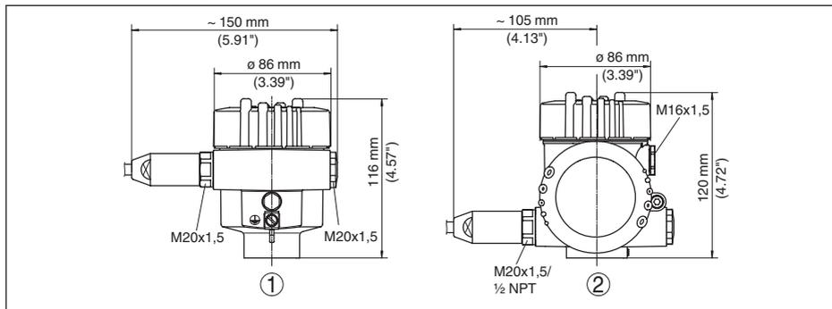
Рис. 48: Корпуса в исполнении IP 66/IP 68 (1 bar) - с установленным модулем индикации и настройки корпус выше на 9 мм/0.35 in
