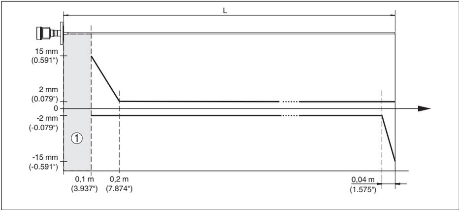
Рис. 41: Погрешность измерения VEGAFLEX 83 в стержневом исполнении с покрытием (среда - вода)
