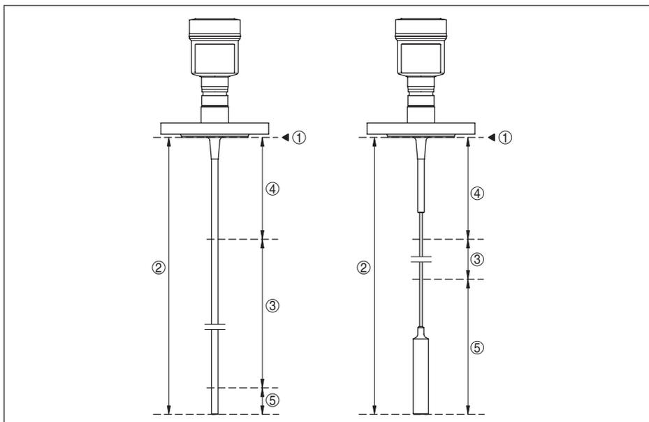
Рис. 40: Диапазоны измерения - VEGAFLEX 83
