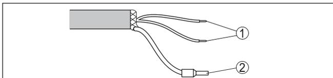
Рис. 20: Назначение проводов постоянно подключенного соединительного кабеля
