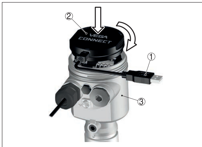
Рис. 27: Подключение ПК через интерфейсный адаптер прямо к датчику
