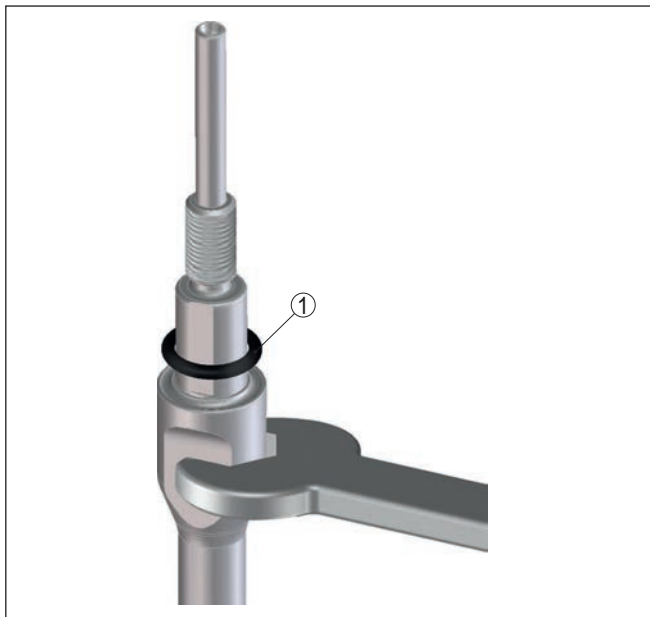
Рис. 41: Замена измерительного стержня
