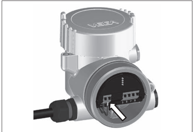
Рис. 12: Шаги подключения 5 и 6 - двухкамерный корпус
