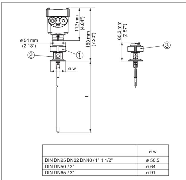
Рис. 10: Автоклавизируемое исполнение
