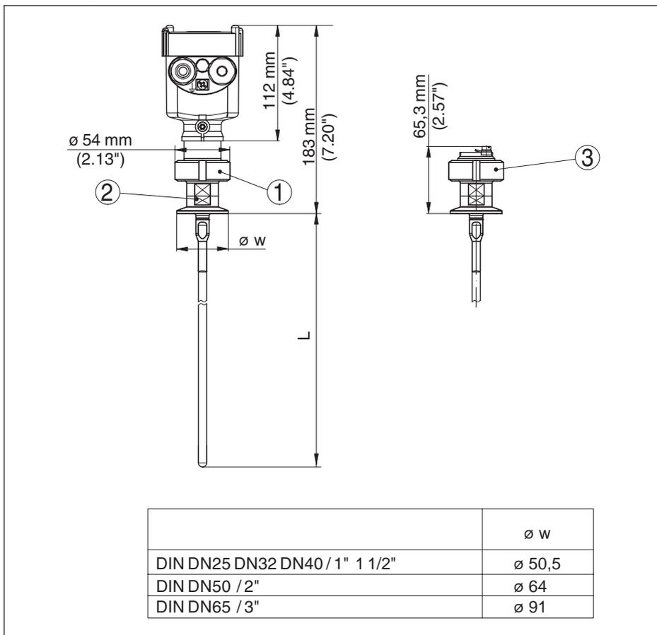
Рис. 64: VEGAFLEX 83, стержневое исполнение  $\varnothing$  8 мм (0.315 in), полированное - автоклавируемое исполнение
