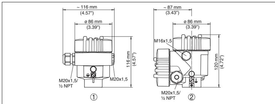
Рис. 59: Корпуса в исполнении IP 66/IP 68 (0,2 bar) - с установленным модулем индикации и настройки корпус выше на 9 mm/0.35 in
