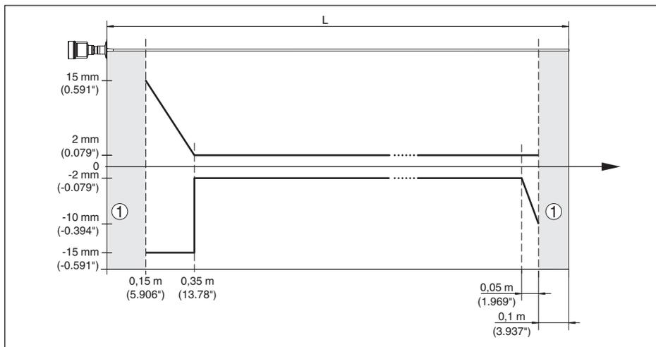
Рис. 53: Погрешность измерения VEGAFLEX 83 в стержневом исполнении (среда - масло)
