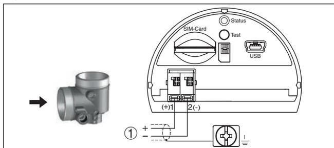
Рис. 20: Отсек подключения встроенного модуля мобильной связи PLICSMOBILE
