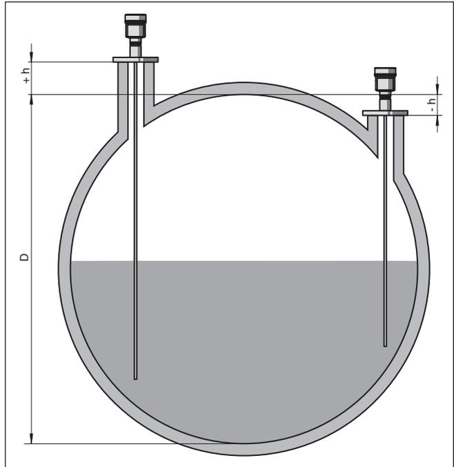
Рис. 25: Высота емкости и значение коррекции патрубка
