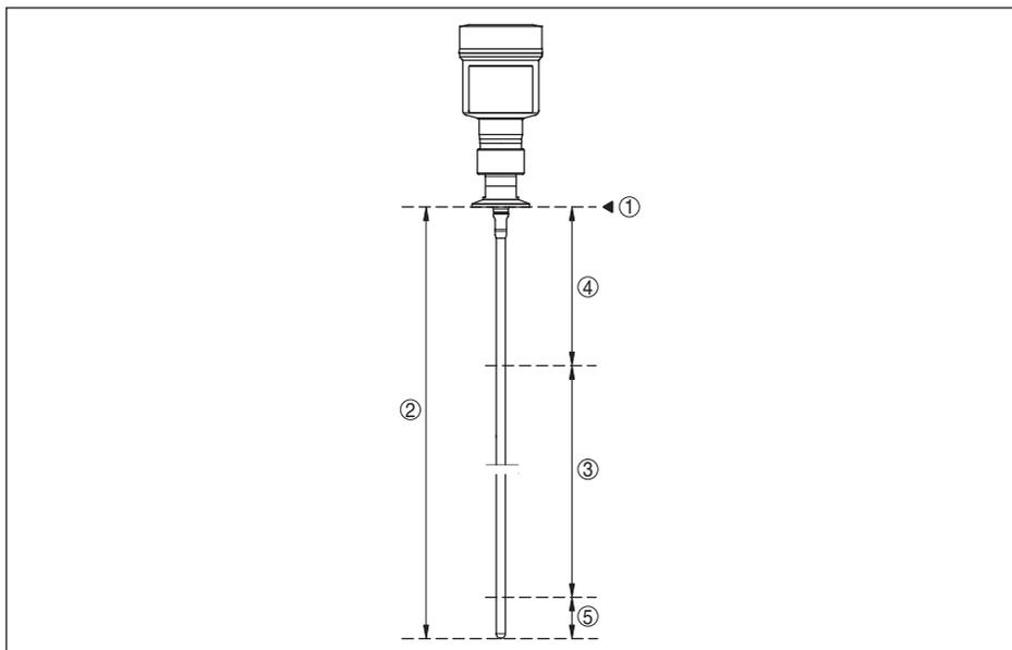
Рис. 51: Диапазоны измерения - VEGAFLEX 83
