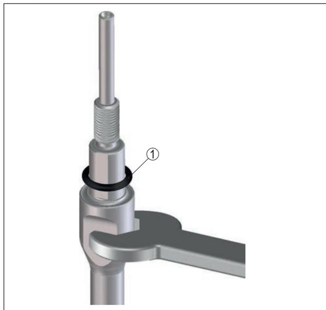
Рис. 49: Замена измерительного стержня
