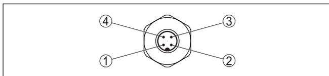
Рис. 18: Вид штекерного разъема M12 x 1
