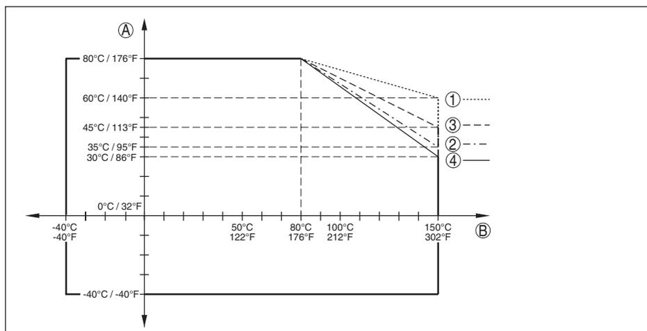
Рис. 54: Температура окружающей среды - температура процесса, стандартное исполнение
