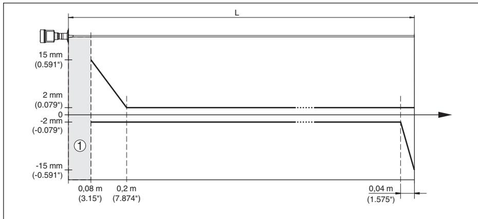
Рис. 52: Погрешность измерения VEGAFLEX 83 в стержневом исполнении (среда - вода)
