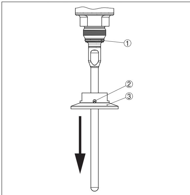
Рис. 50: Уплотнение присоединения к процессу
