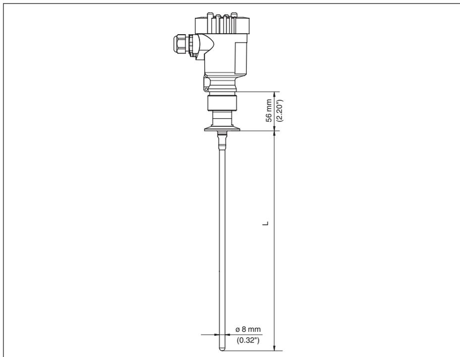
Рис. 63: VEGAFLEX 83, стержневое исполнение  $\varnothing 8$  mm (0.315 in), полированный
