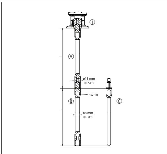
Рис. 65: Удлинительные сегменты стержня  $\varnothing 8$  мм (0.315 in)
