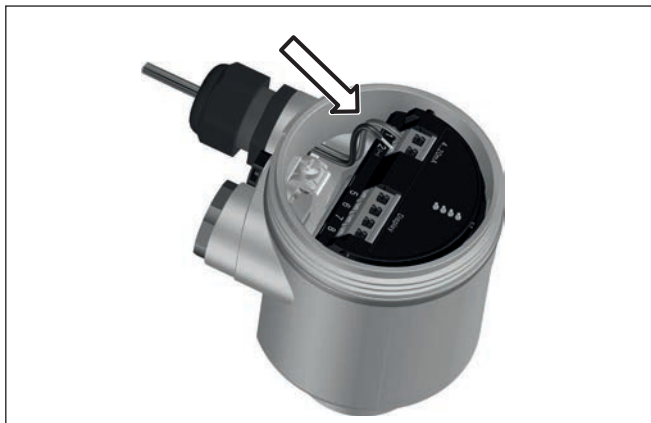
Рис. 7: Шаги подключения 5 и 6 - однокамерный корпус
