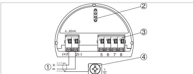
Отсек электроники и подключения (однокамерный корпус)
