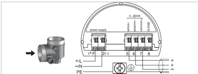
Отсек подключения в двухкамерном корпусе - сетевое напряжение
