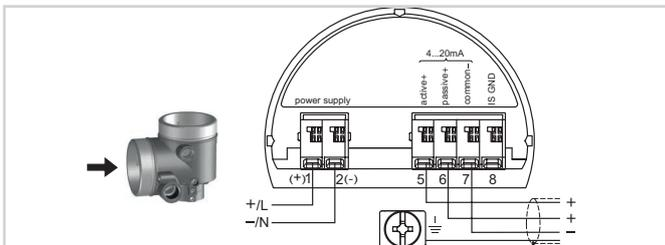
Отсек подключения в двухкамерном корпусе - малое напряжение
