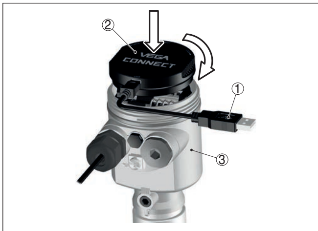
Рис. 19: Подключение ПК через интерфейсный адаптер прямо к датчику
