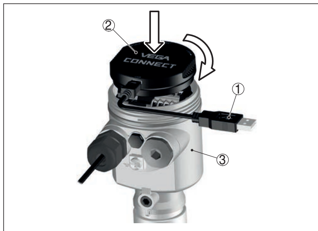
Рис. 28: Подключение ПК через интерфейсный адаптер прямо к датчику
