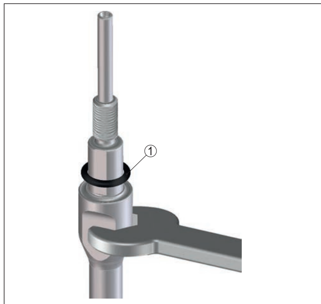
Рис. 44: Замена измерительного стержня
