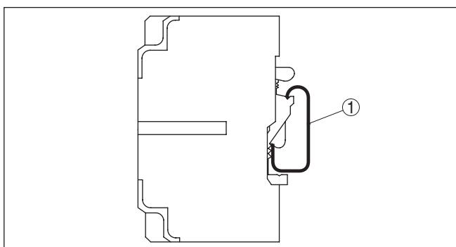
Рис. 3: Монтаж на несущей рейке по EN 50 035 (G-образная рейка)
