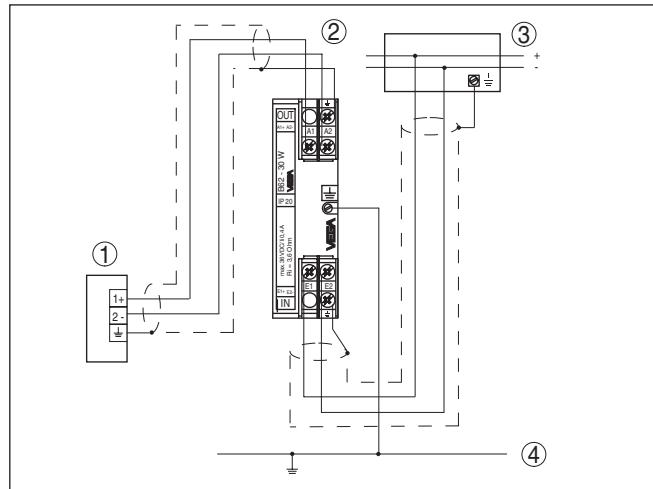
Рис. 8: Схема подключения устройства защиты от перенапряжений B62-30W
