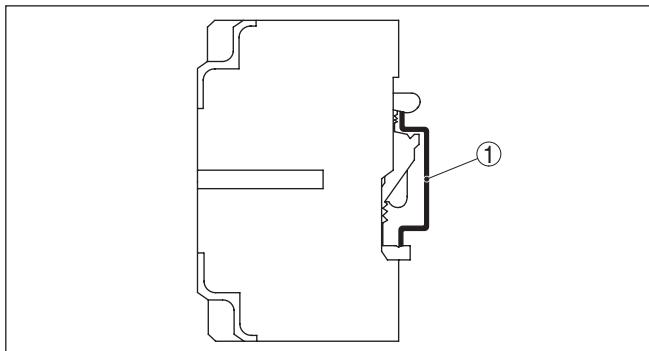
Рис. 2: Монтаж на несущей рейке по EN 50 022 (U-образная рейка)
