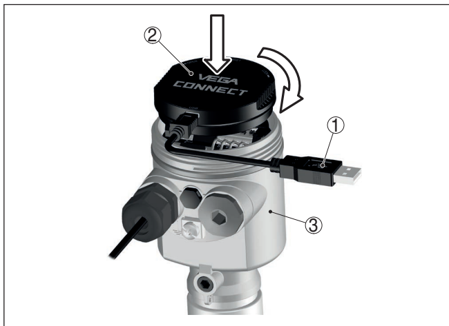
Рис. 34: Подключение ПК через интерфейсный адаптер прямо к датчику
