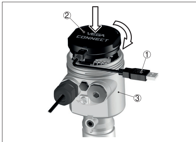
Рис. 41: Подключение ПК через интерфейсный адаптер прямо к датчику
