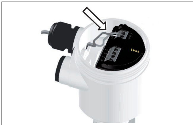
Рис. 25: Шаги подключения 5 и 6 - однокамерный корпус
