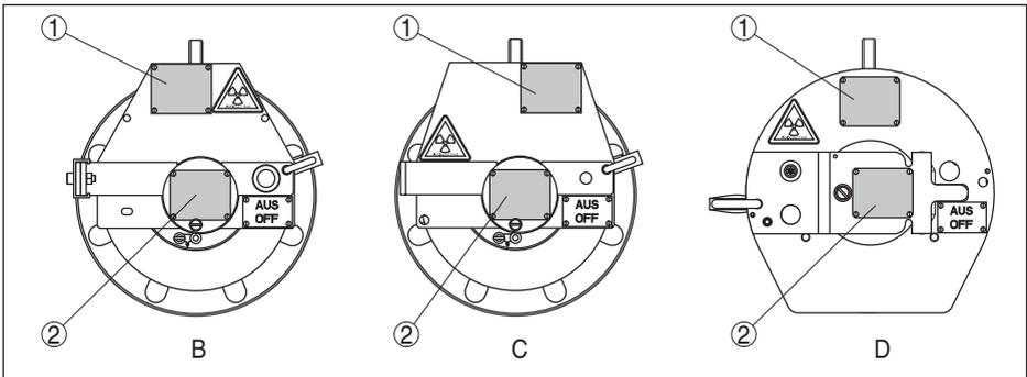
Рис. 5: Положение типовых шильдиков - Исполнения В С D
