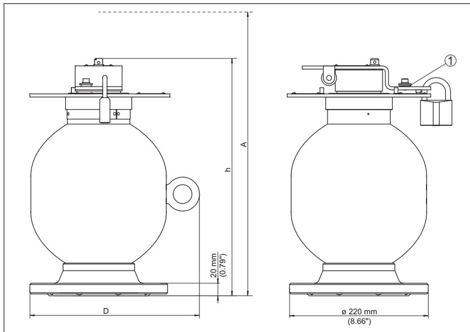
Рис. 43: Держатель источника VEGASOURCE 35 - Исполнение D
