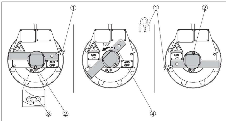
Рис. 28: Включение излучения - VEGASOURCE 35 Исполнение С
