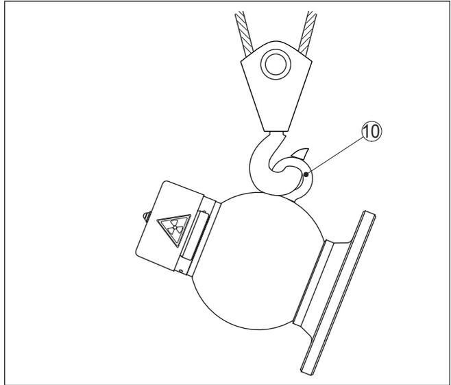
Рис. 13: Транспортировка защитного держателя источника краном
