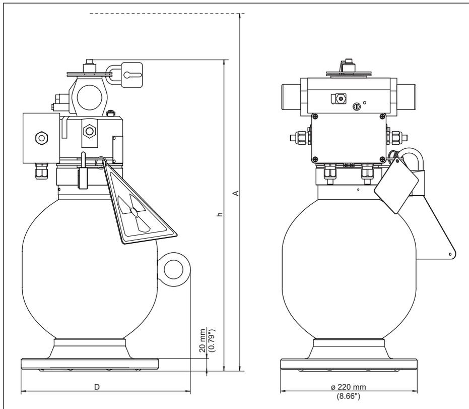
Рис. 44: Держатель источника VEGASOURCE 35 - Исполнение К и L
