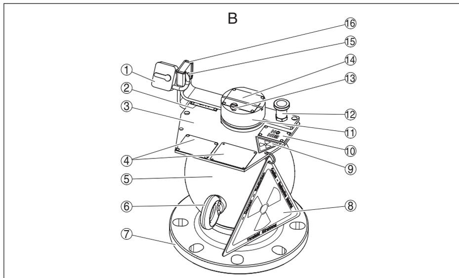
Рис. 34: Материалы VEGASOURCE 35 - Исполнение устройства В
