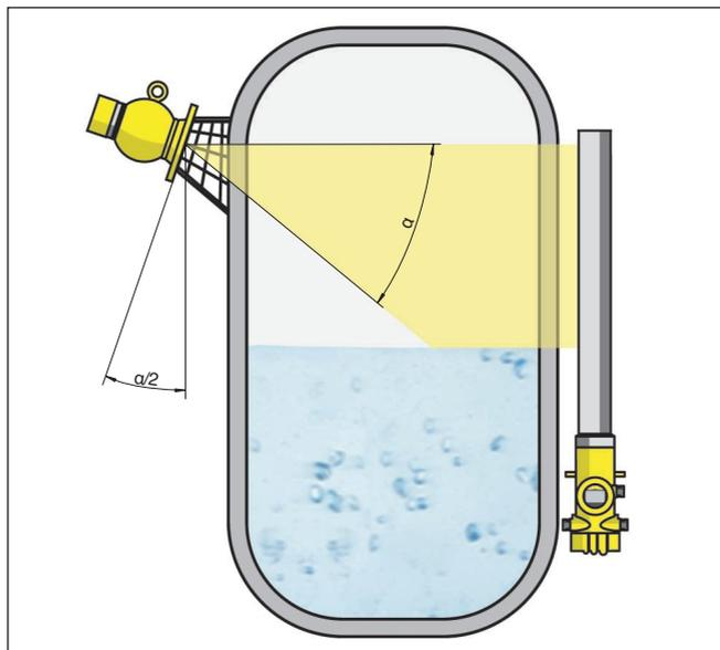
Рис. 14: Монтажное положение и направление держателя источника
