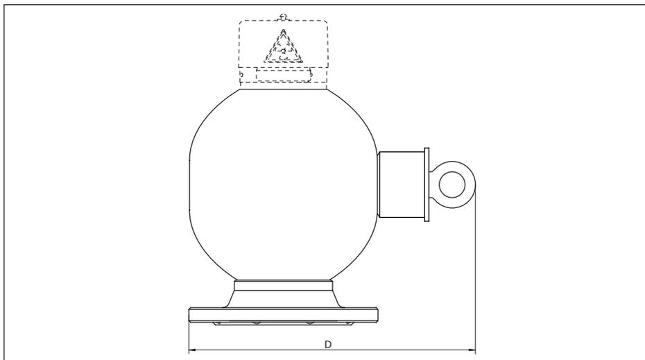
Рис. 47: Держатель источника VEGASOURCE 35 - огнестойкое исполнение (вариант)
