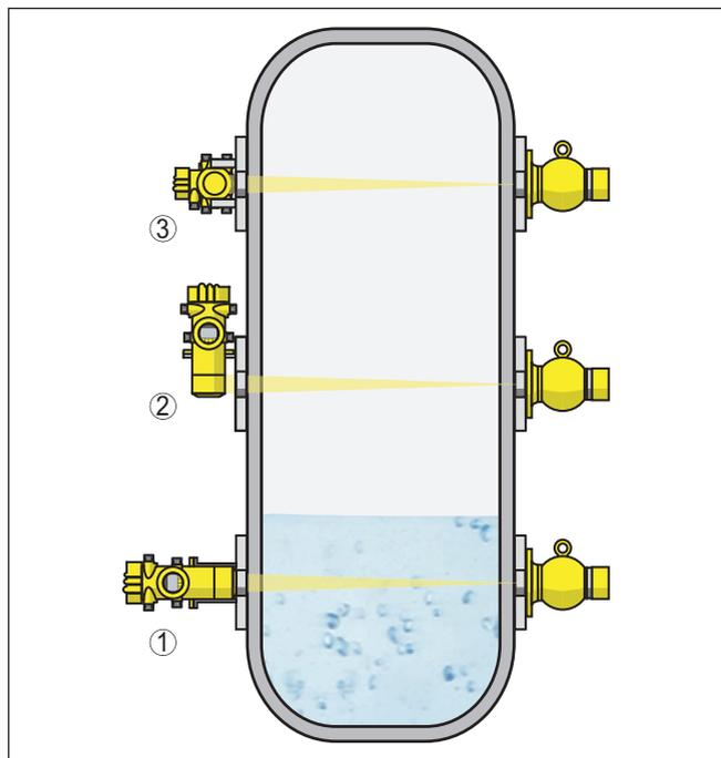
Рис. 15: Монтажные положения - сигнализация уровня с MINITRAC 31
