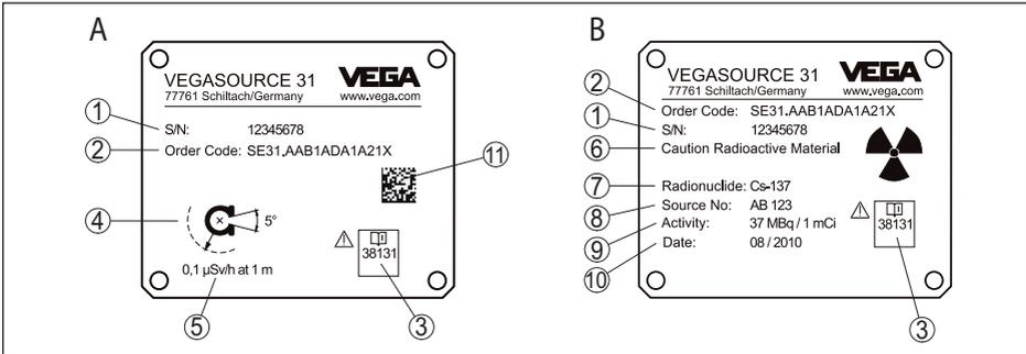
Рис. 6: Типовой шильдик - Исполнение В С D
