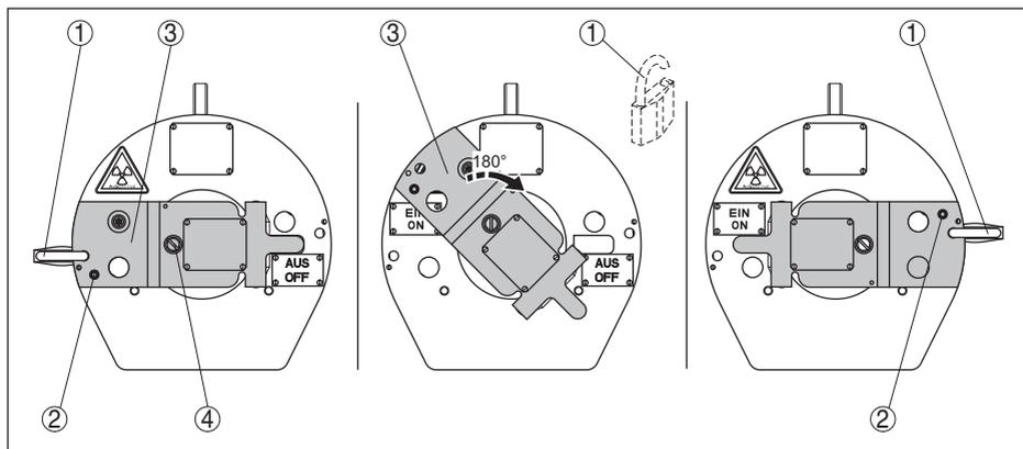
Рис. 29: Включение излучения - VEGASOURCE 35 Исполнение D
