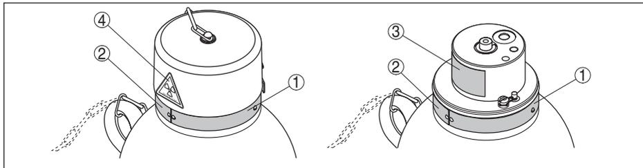
Рис. 3: Положение типовых шильдиков - Исполнение А
