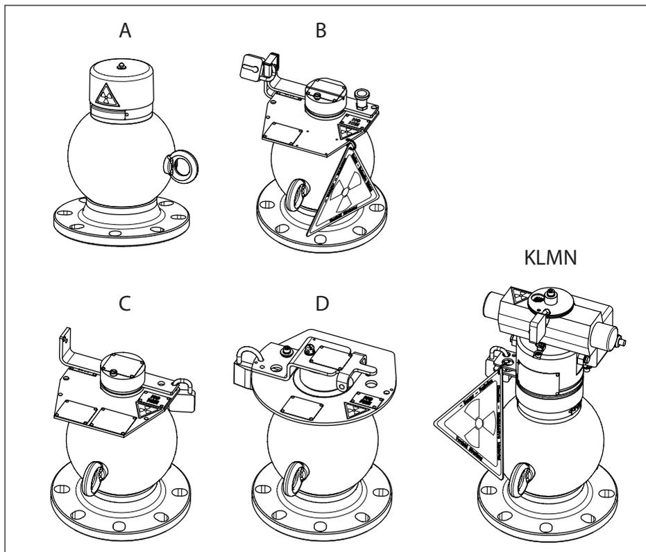
Рис. 2: Исполнения VEGASOURCE 35 - общий обзор
