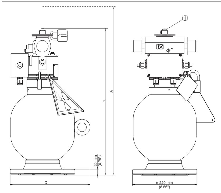
Рис. 45: Держатель источника VEGASOURCE 35 - Исполнение М и N
