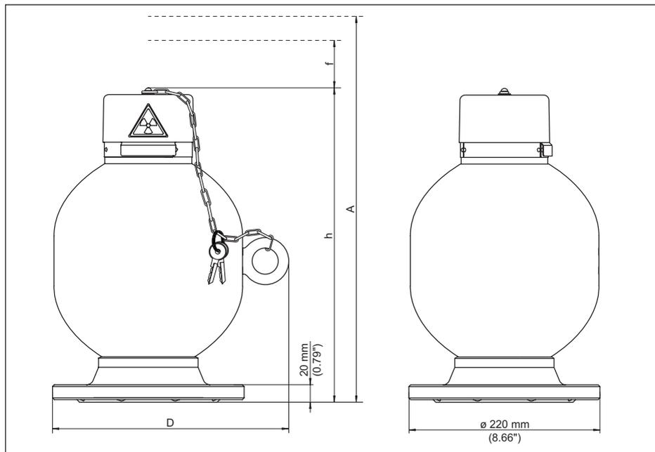
Рис. 40: Держатель источника VEGASOURCE 35 - Исполнение A (вставка с препаратом с ручным переключением ВКЛ/ВЫКЛ, вставной замок для запираения положения ВКЛ или ВЫКЛ, защитный кожух)
