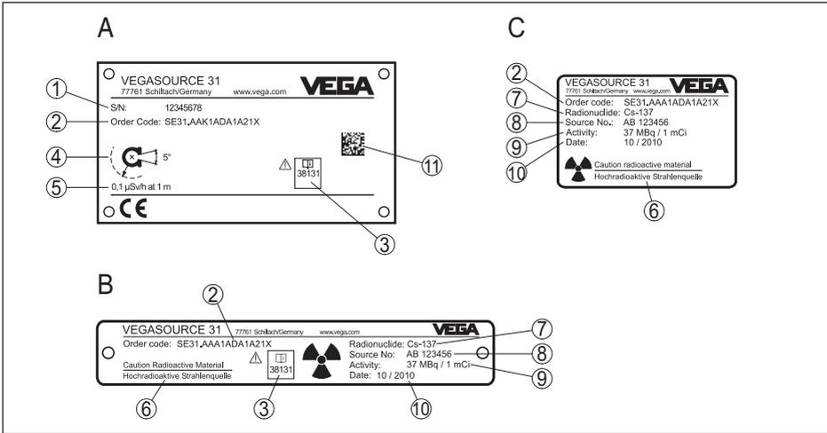
Рис. 8: Типовой шильдик - Исполнение K L M N
