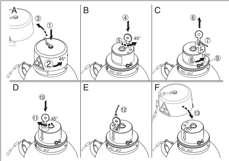
Рис. 26: Включение излучения - VEGASOURCE 35 Исполнение А
