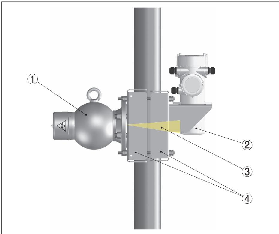
Рис. 49: Зажимное приспособление для монтажа на трубе 50 ... 220 мм (1.97 ... 8.66 in) с просвечиванием под углом 30°
