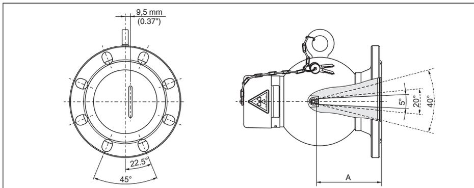
Рис. 46: Канал выхода луча (например, Исполнение А)
