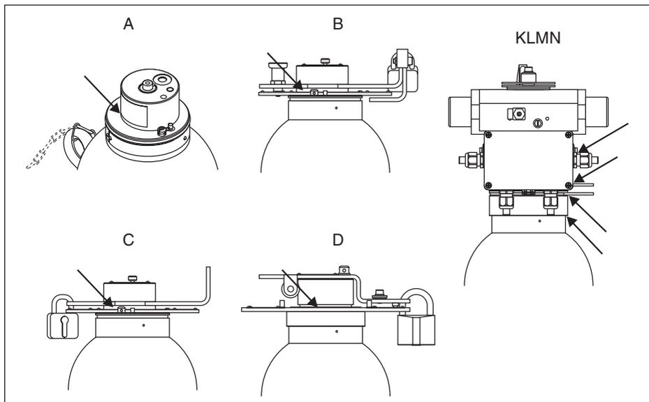
Рис. 32: Поверхности для отбора проб методом обтирания
