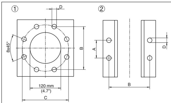
Рис. 23: Монтажное приспособление, имеющееся на месте применения
