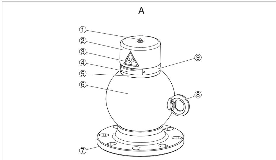
Рис. 33: Материалы VEGASOURCE 35 - Исполнение устройства А
