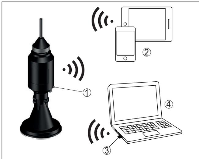
Рис. 3: Беспроводное соединение со стандартными устройствами для настройки
